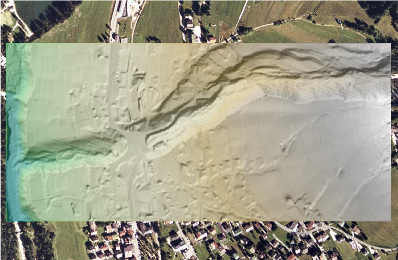
Figura 87 – DTM utilizzato per l'implementazione del modello di propagazione delle colate detritiche agli automi cellulari (Gregoretti Degetto 2012)
